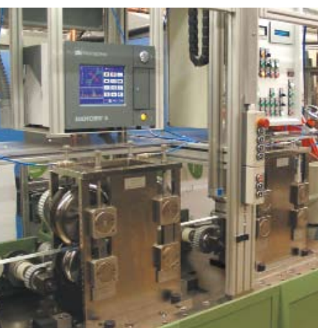
Проверка качества сварного шва алюминиевых радиаторных труб
