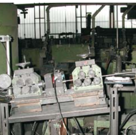
Контроль качества проволоки на волочильных машинах
