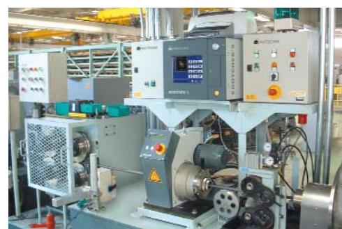
Поточный контроль качества пружинной проволоки
