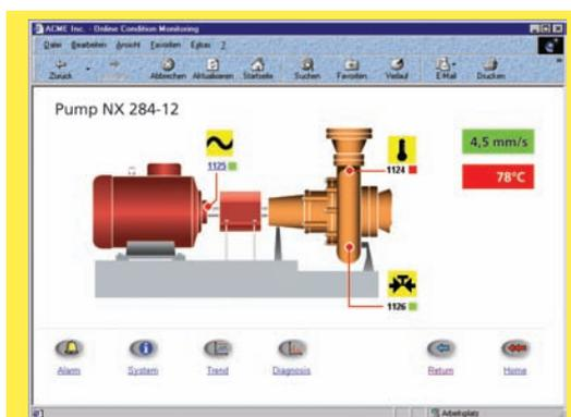
Пользовательский интерфейс с обзором состояния машины и сигнализаций (дополнительно).
